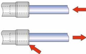
**Montage:** Schlauch bis zum Anschlag in den Anschluss stecken
